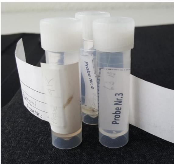
Beispiel: Schritt 4. Idealerweise sehen die Proberöhrchen so aus. Die Etiketten sind festgeklebt, die Probenummer befindet sich direkt im Röhrchen und es ist auf dem Sammelprotokoll vermerkt, zu welcher Quellfassung sie gehört.
