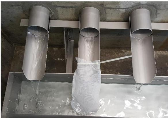
Beispiel: Schritt 1 des «Sammeln ab dem Einlaufrohr». Die Kunststoffringe wurden weggeschnitten.
