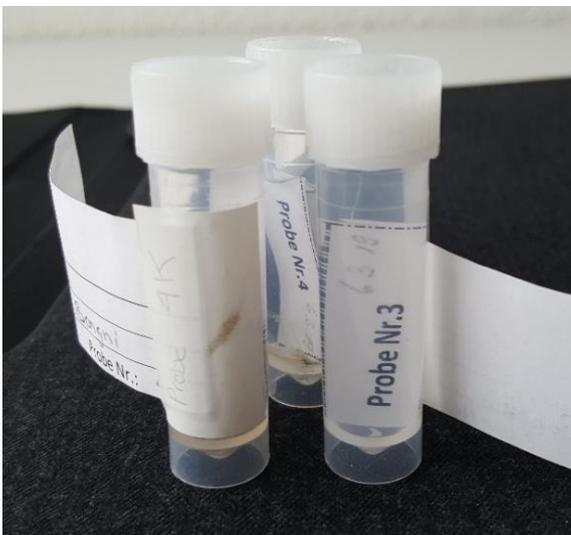
Exemple : Étape 4 : Idéalement, les tubes échantillons ressemblent à ceci. Les étiquettes sont collées, le numéro de l'échantillon se trouve directement dans le tube et il est noté sur le protocole de prélèvement auquel il appartient.
