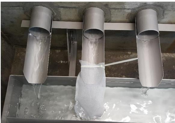
Exemple : Etape 1 de "Prélèvement sur le tuyau d'aspiration". Les anneaux en plastique ont été coupés.
